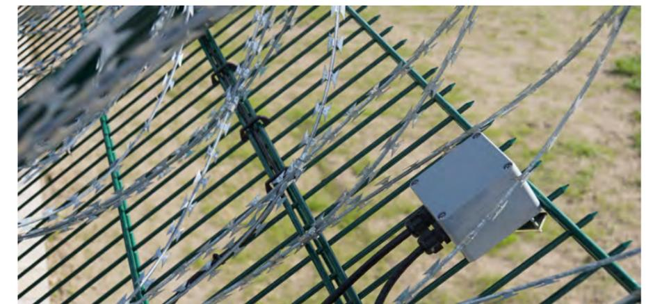
Die Segmentierungseinheiten sorgen für eine exakte Trennung der Meldezonen
