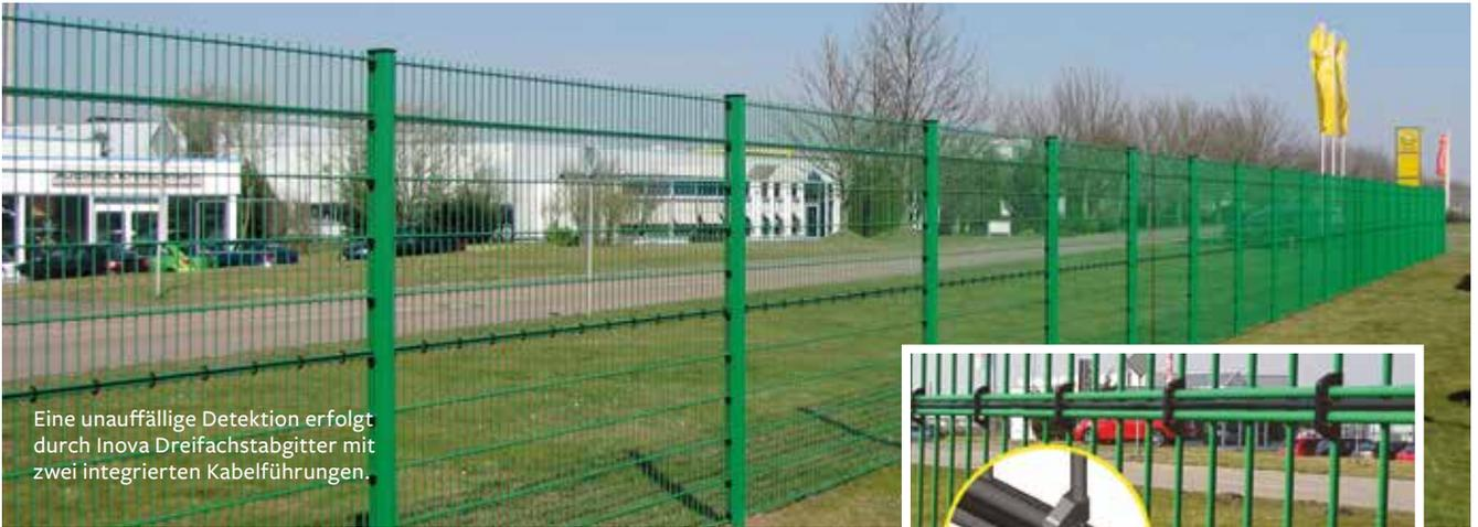
Eine unauffällige Detektion erfolgt durch Inova Dreifachstabgitter mit zwei integrierten Kabelführungen.
